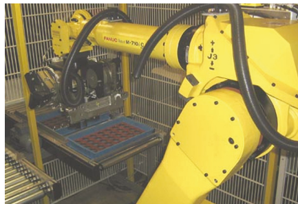
Leistungshohnen auf einer Fässler HMX400, Roboter zur Maschinenbestückung, vereinfachtes Prinzip des modularen Baukastens (v.l.)
